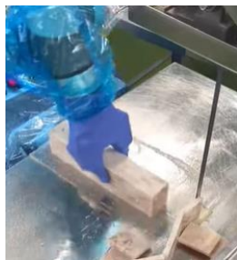
冷凍の魚を凍ったままカットする工程でロボグローブが使用されています！
